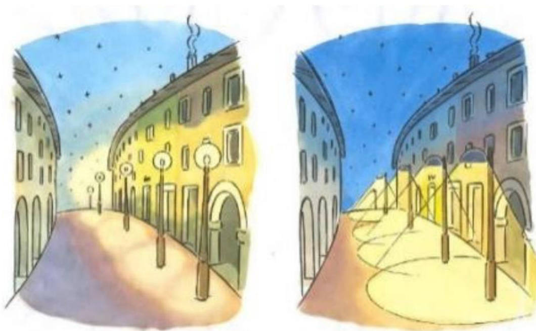
Figura 136 - Esempio di due tipologie di illuminazione pubblica all'interno di un comune: a sinistra la tipologia sconsigliata con il flusso luminoso rivolto verso la volta stellata, mentre a destra la tipologia corretta con illuminazione verso il basso.
